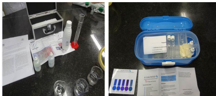
Figuras 1 e 2: Kits experimentais pedagógicos para análise de água
