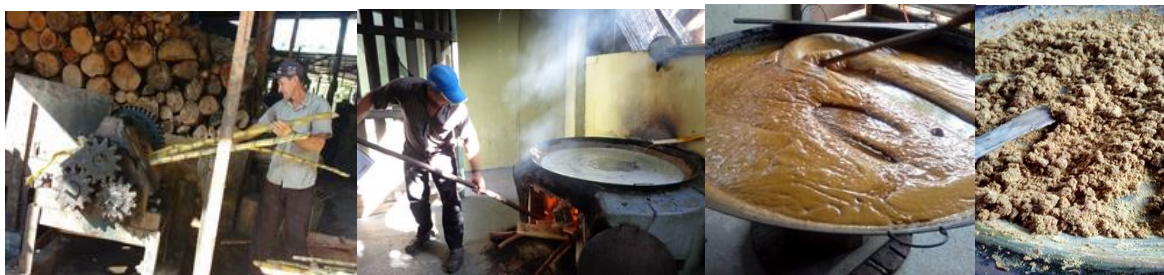
Figuras 3. Etapas do processo de produção de açúcar artesanal. Etapa 1. Produção do caldo de cana (moenda). Etapa 2. Evaporação da água (cozimento no tacho). Etapa 3. Início da cristalização do açúcar mascavo, com atingimento do ponto do melaço. Etapa 4. Após a secagem do líquido, o resultado é o açúcar mascavo. Fonte: Banco de dados do grupo de investigação.
